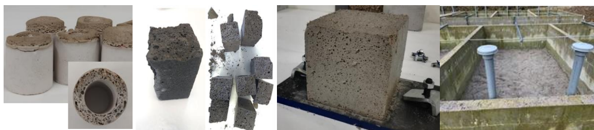
Figura 1. Materiales geopoliméricos fabricados en el marco del proyecto GEOPOLAR. De izqda. a dcha: a) geopolímero poroso conformado como cilindros para adsorción b) grava porosa para adsorción c) Hormigón geopoliméricos para construcción d) imagen del humedal donde será implantado el material adsorbente.
